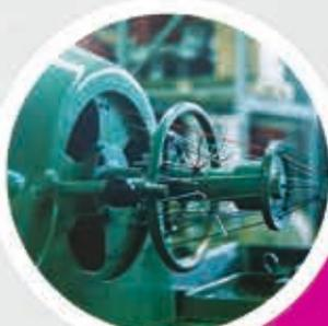
I cavi multiconduttori realizzati con passo di twistatura atto a garantire la migliore flessibilità
